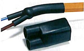
Ces pièces moulées thermo-rétractables sont fabriquées en différentes matières (polyester élastomère, polyoléfine ou fluoro-élastomère réticulés). Les pièces de dérivation sont utilisées pour isoler le point d'épanouissement et garantir l'étanchéité d'un câble à l'endroit où il se sépare en plusieurs conducteurs, mais aussi pour répartir les contraintes mécaniques
